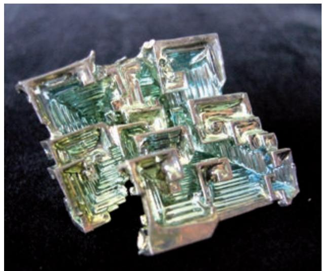
Abb. 1: Elementares Bismut, das durch langsames Erstarren aus der Schmelze erhalten wurde. Die Anlauffarben sind Folge oberflächlicher Oxidation. (Foto: Michael Ruck, TU Dresden)
