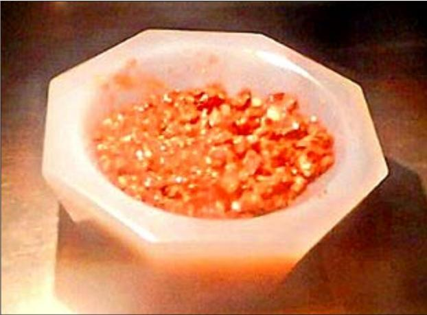
Abb. 2: Eine Probe Caesiumoxid,  $\text{Cs}_2\text{O}$ . (Foto: C. Hoch, LMU München)
