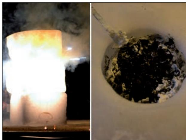
Abb. 2: Magnesium verbrennt unter sehr greller Lichterscheinung in Trockeneis (links) und reduziert  $\text{CO}_2$  zu Kohlenstoff (rechts, Blick in den Trockeneisblock nach der Reaktion).
