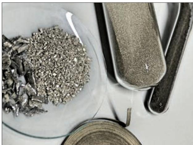
Abb. 1: Auf der Uhrglasschale: Grignard-Späne und Magnesiumgranalien; in den Schlenkgefäßen: Magnesiumpulver und aktives Rieckmagnesium; Magnesiumband unten in der Bildmitte.
