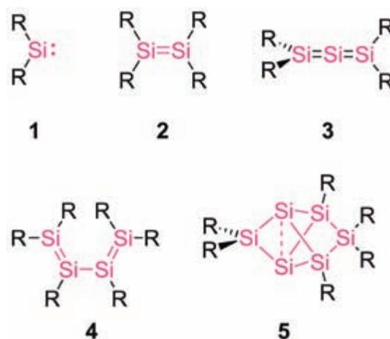
Abb. 3: Ungesättigte Siliciumverbindungen mit steigender Komplexität: Silylene 1, Disilene 2, Trisilaallene 3, Tetrasilabutadiene 4 und thermodynamisch stabilstes Isomer von Hexasilabenzol 5 (R = räumlich anspruchsvoller Substituent). (David Scheschkewitz, Univ. Saarbrücken)
