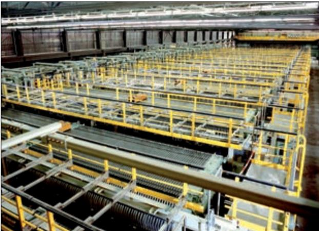
Abb. 2: Zellenraum einer Membrananlage der BASF in Ludwigshafen (Quelle: BASF).
