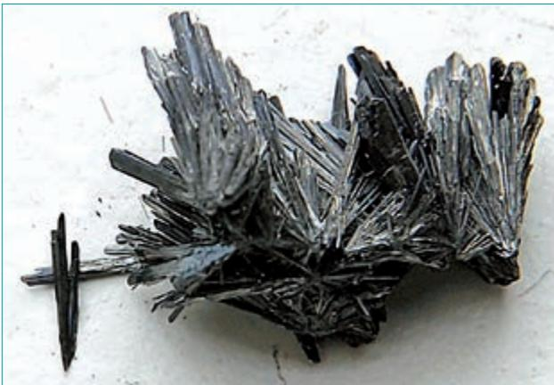
Abb. 1: Das Antimonmineral Stibnit ( $\text{Sb}_2\text{S}_3$ ), das orthorhombisch in der Raumgruppe *Pnma* kristallisiert (Bildquelle: www.steinoase.ch).
