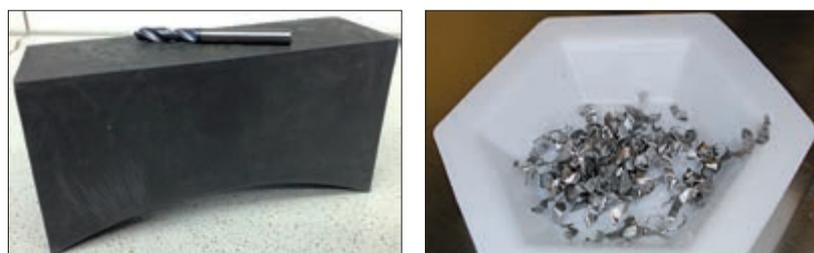
Abb. 4: Ein „Formstein“ aus Uran (8,27 kg; 99,597%  $^{238}\text{U}$ ; ursprünglich zur Abschirmung ionisierender Strahlung verwendet) und daraus durch Bohren frisch gewonnene Uranspäne. (Foto: Andreas Scheurer, FAU)
